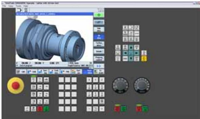
SinuTrain for SINUMERIK Operate 是一个基于计算机的 CNC 编程软件，它以原装 CNC 内核为基础。
