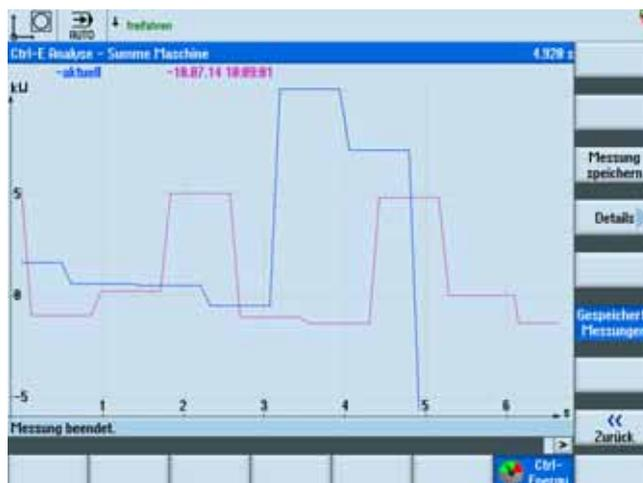
以图形形式比较两次测量，用于专业分析机床消耗的能源
