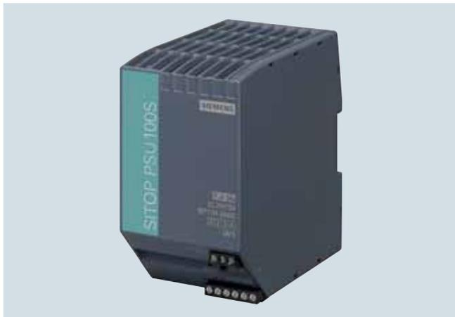
SITOP 系列的 24 V 电源特别适用于工业领域并可在一次侧同步模式下工作。由于输出电压可以精确控制，该设备甚至可以用于连接敏感的传感器。根据输出电流和应用领域，可提供多种规格型号。
